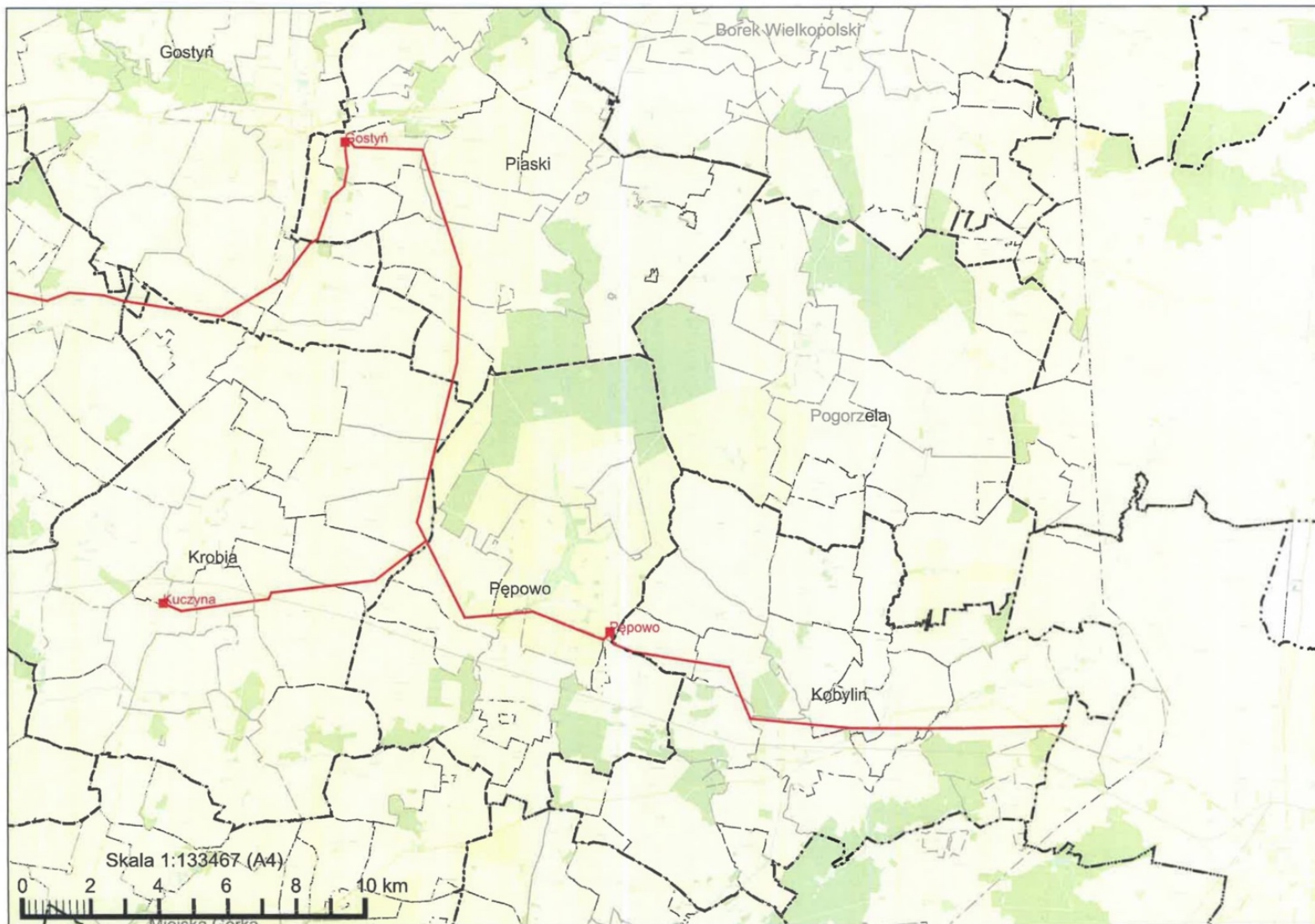
Rysunek 13. Schemat sieci elektroenergetycznej wysokiego napięcia na terenie Gminy Pępowo.
